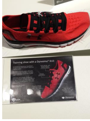
(b) Dyneema içeren ve çözgüllu örme işlemiyle üretilmiş spor ayakkabı üst bölümü
