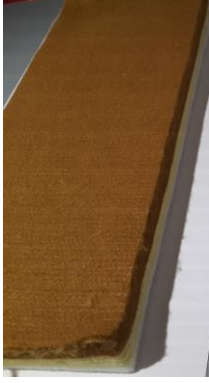
(a) Uzay gemisi yalıtım keçesi (PBI/para aramid/meta aramid)
