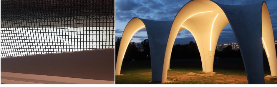
Şekil 14: Karbon Takviyeli Beton ve Uygulama Örneği
